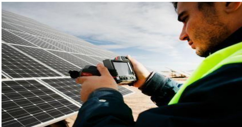
Hình 9a. Sử dụng camera nhiệt quan sát nhiệt độ bề mặt tấm pin
